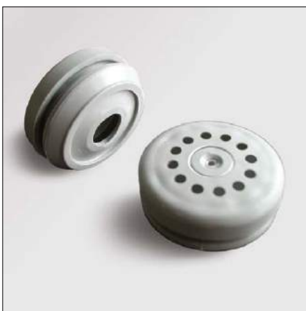
Вентиляционная заглушка с лабиринтным уплотнением для предотвращения образования конденсата; IP x 4; для стенок толщиной 1.5 - 4.5 мм
