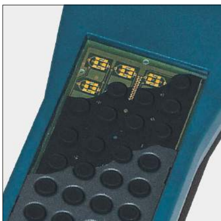
Комплект пленочной клавиатуры включает защитный слой клавиатуры, силиконовую пленку с кнопками и печатную плату с кабелем
