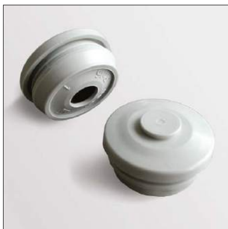
Заглушка с двойной мембраной IP 66, с 2 интегрированными уплотнительными мембранами, плотная посадка без контргайки, для стенок толщиной 1.5 - 4.5 мм
